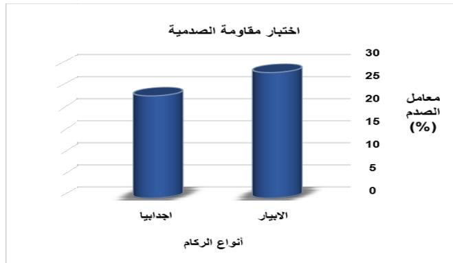
الشكل (12): مقارنة اختبار الصدمية.
